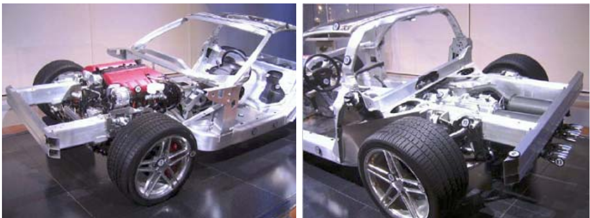
Fig. 3-8: Spaceframe Chevrolet Corvette Z06 [FRO06]
